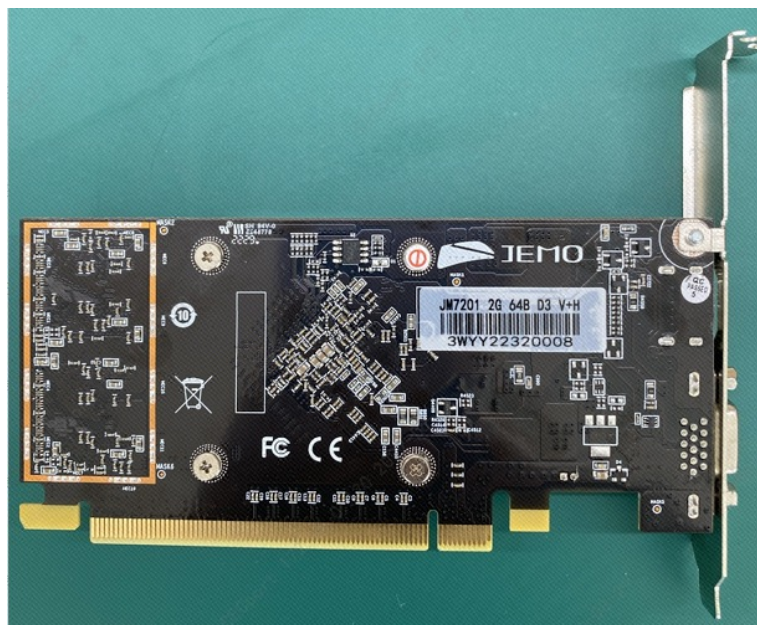
默认配置产品实物图背面（全高挡片 +HDMI+VGA 接口）
