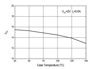
$h_{\text{FE}}\, vs.$  Case Temperature
