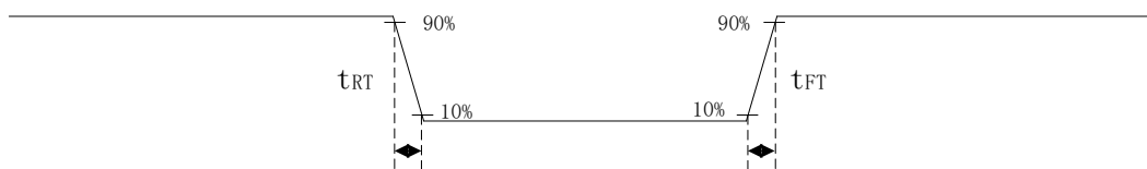
图 2.18 GPIO 开关特性图
